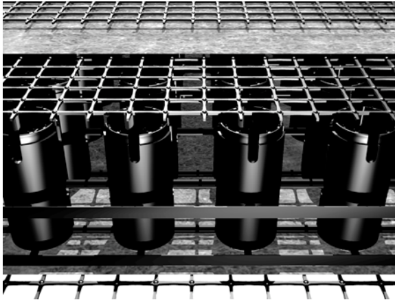
Geogrid layer #3 Geotextile (encases Rainstore3) Geogrid layer #2 Rainstore3 units Geotextile (encases Rainstore3) Geogrid layer #1
